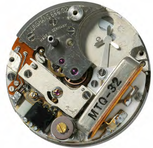
Werk zu Armbanduhr Junghans Astro Quartz um 1974 Photo: Deutsches Uhrenmuseum
